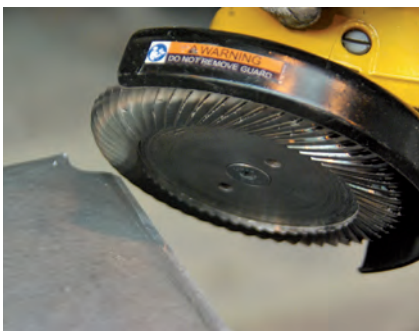
Fräsen einer Fase mit dem Fräsring
